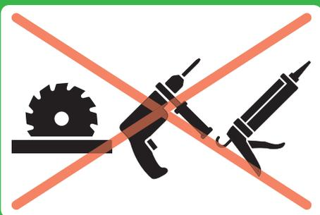
Kein Schneiden und kein Bohren der Profile, kein Verkleben!
